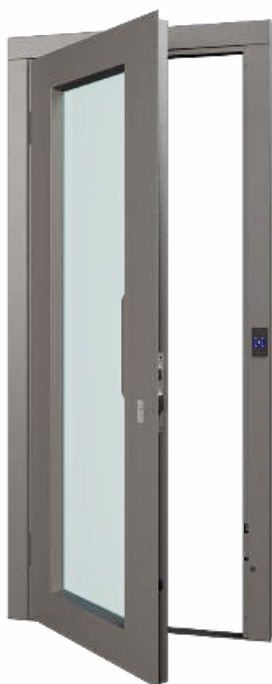
4 ND3 VETRATA IN LAMIERA VERNICIATA CON MANIGLIA INTEGRATA (serratura con chiave in esterno e manopola girevole interna)
